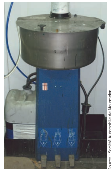
Machine à laver les pistolets de peinture
